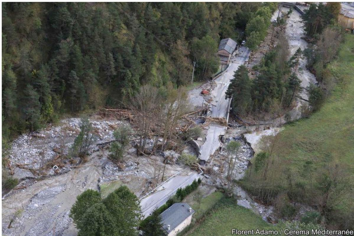
**Figure 22** : Dépôt massif en amont du pont de Viévola sur la Roya.
