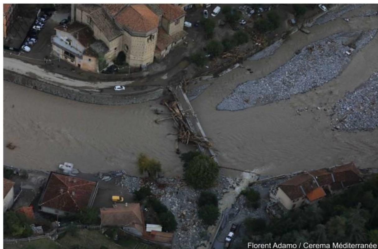
**Figure 47 :** Pont Charabot obstrué par les flottants.
