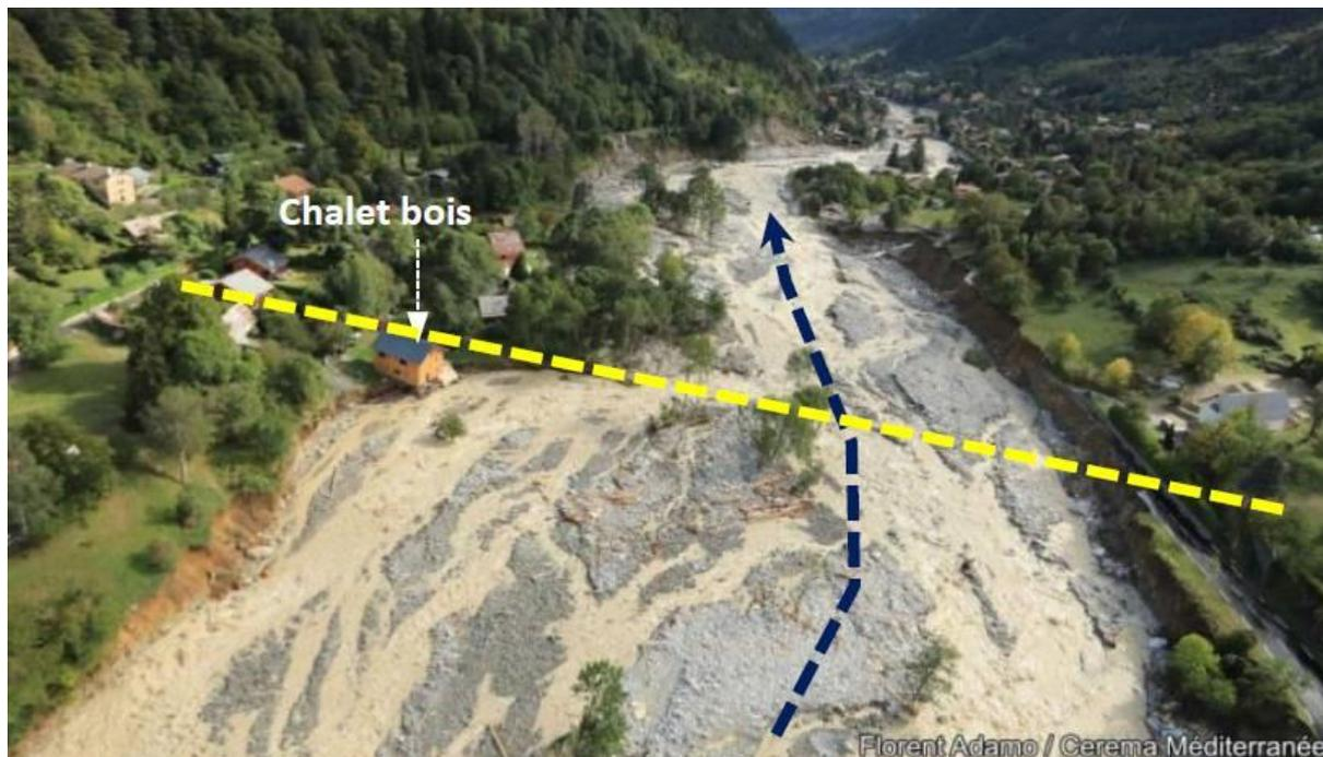
**Figure 9** : Exemple d'érosion des versants et de dépôt dans le lit sur le Boréon.
