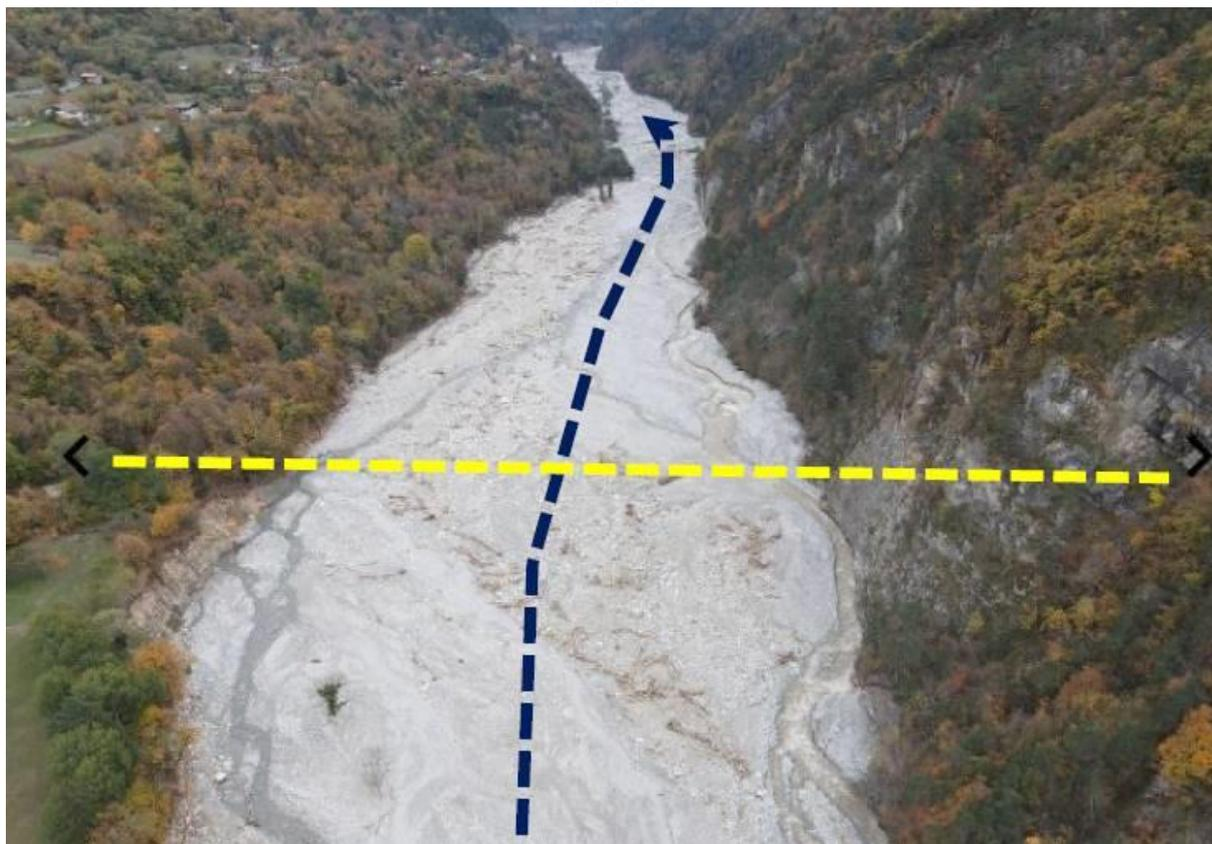
**Figure 14** : Dépôt massif dans la zone de réduction de pente en aval du Boréon.
